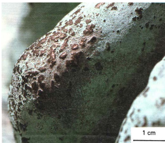
Slika 2.3. Bronca izložena vanjskoj atmosferi koja je pod utjecajem okolišnih uvjeta i kisele kiše izgubila veliki dio svoje izvorne površine. 22
