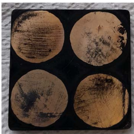
Slika 4.60. Ispitivanje prionjivosti premaza na patiniranoj površini bronce.
