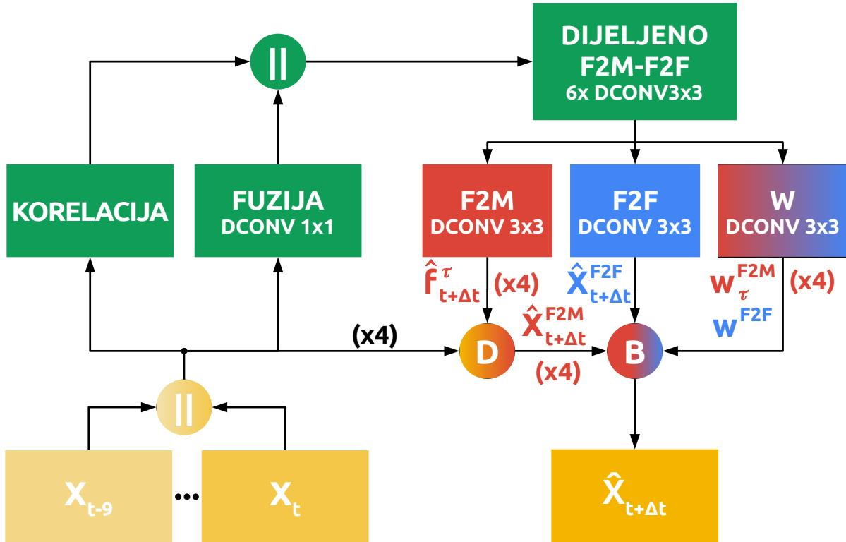
**Slika 5.2:** Struktura predloženog modela za prognoziranje zasnovanog na kombinaciji izravnog prognoziranja značajki i prognoziranja značajki deformacijom prošlih reprezentacija u skladu s predviđenim tokom.
