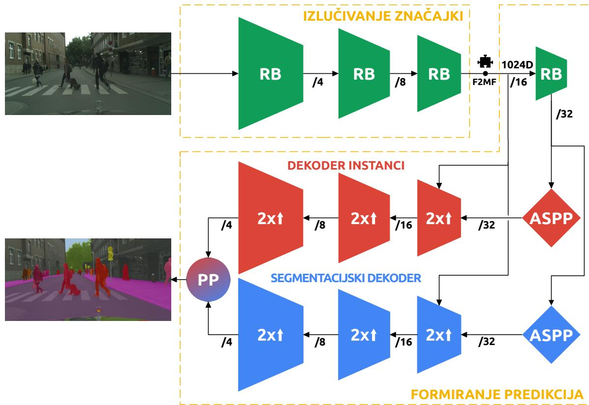
**Slika 4.3:** Modificirana inačica modela za panoptičku segmentaciju Panoptic Deeplab s jednom preskočnom vezom. Prednji dio modela (eng. *feature extraction*) izlučuje apstraktne konvolucijske značajke, dok stražnji dio modela (eng. *semantic formation*) provodi prožimanje značajki i konteksta (ASPP) te naduzorkovanje s jednom preskočnom vezom. Crna slagalica označava značajke na kojima ćemo primijenjivati naš prognostički model (F2MF).
