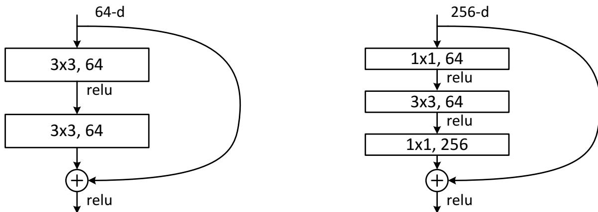
**Slika 2.1:** Primjer rezidualnih konvolucijskih jedinica - gradivnih elemenata arhitekture ResNet. Lijevo: osnovna rezidualna jedinica (eng. *basic block*). Desno: rezidualna jedinica sa uskim grлом (eng. *bottleneck*). Slika preuzeta iz [26].
