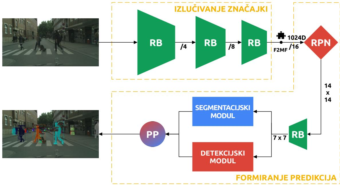
**Slika 4.2:** Model za segmentaciju instanci Mask R-CNN C4 sa okosnicom ResNet-50. Prednji dio modela (eng. *feature extraction*) izlučuje apstraktne konvolucijske značajke, dok stražnji dio modela (eng. *semantic formation*) predlaže kandidate primjeraka (RPN) u kojima primjenjujemo interpolacijsko sažimanje te odvojene glave za detekciju okvira i regresiju segmentacijske maske. Crna slagalica označava značajke na kojima ćemo primjenjivati naš prognostički model (F2MF).
