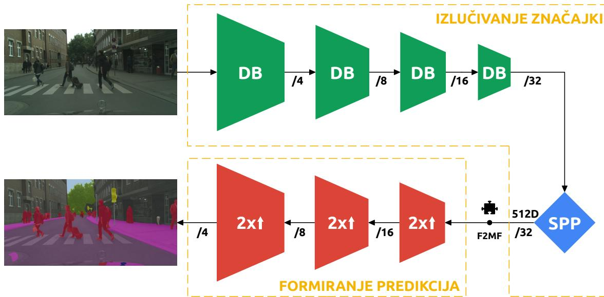
**Slika 4.1:** Predloženi model za semantičku segmentaciju u jednoj slici temeljen na arhitekturi SwiftNet bez preskočnih veza sa okosnicom DenseNet-121. Prednji dio modela (eng. *feature extraction*) izlučuje značajke, dok ih stražnji dio modela (eng. *semantic formation*) pretvara semantičke predikcije. Crna slagalica označava značajke na kojima ćemo primjenjivati naš prognostički model (F2MF).
