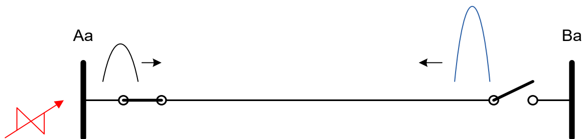
Slika 3.3 Propagacija testnog signala vodom u praznom hodu
