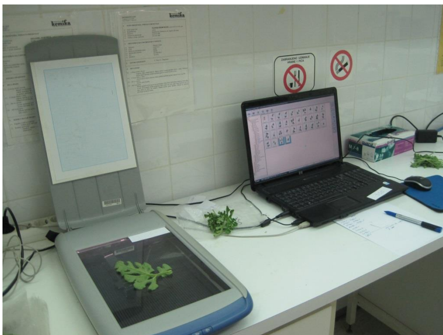
Slika 14. Skeniranje lista i izračun površine lista programom ImageJ 1.43
